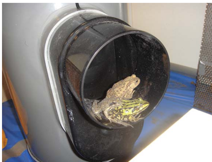
Foto 9: In de proefopstelling (2011) hebben een gewone pad en een bastaardkikker door klimmen en springen de afvoerbuis (kolkaansluiting) weten te bereiken. In straten kunnen ze op deze manier vanuit de opvangbak in het rioolstelsel terecht komen, van waaruit er vaak geen weg terug is. Zie ook foto omslag.
