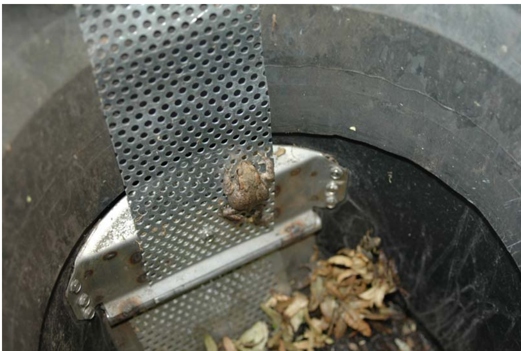
Foto 37: Nog tijdens de inbouw maakten dieren al gebruik van de uitklimstrip. Een gewone pad wist meteen deze ontsnappingsroute te benutten.
